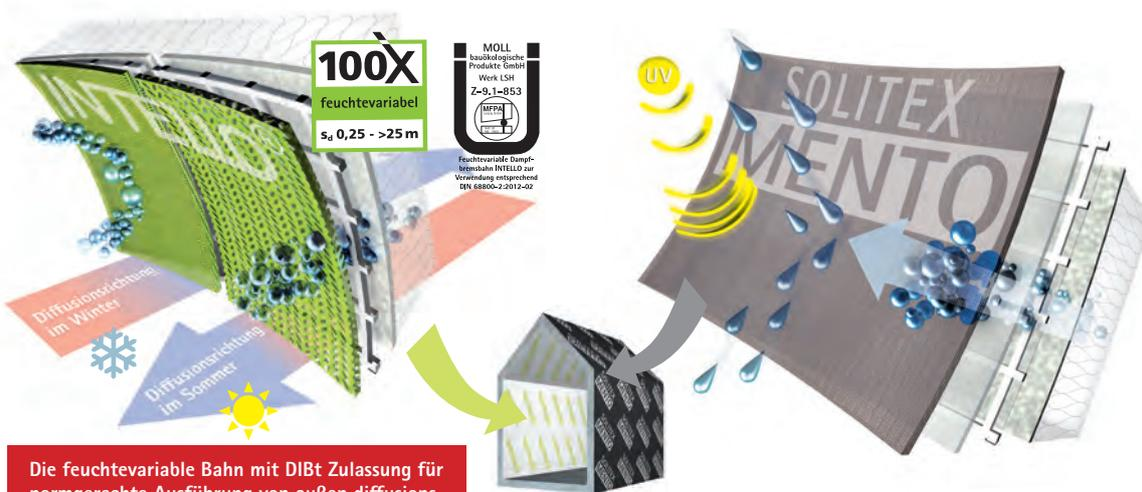
Die feuchtevariable Bahn mit DIBt Zulassung für normgerechte Ausführung von außen diffusionsdichten Konstruktionen nach DIN 68800-2
