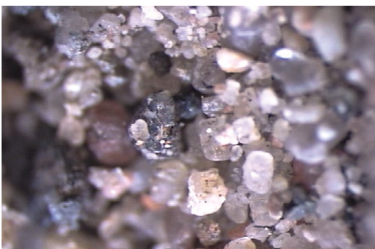
Abb. 1: Feinanteil (< 120 µm, Bildbreite 7,1 mm) von Bauschutt, der als Schotterersatz auf einer Hallenzufahrt eingebaut wurde (Quelle: IFA der DGUV)
